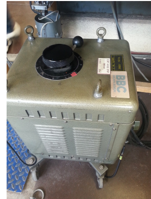
Figuur 1.4: De autotransformator in de set-up. De zwarte draaiknop bovenaan regelt de wikkelvingsverhouding.
